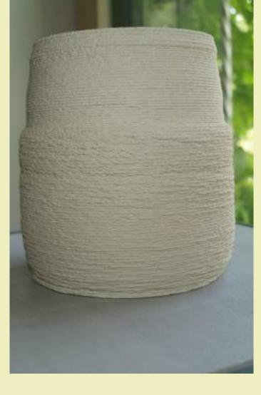
La miscela geopolimerica è il risultato di un processo di dissoluzione e polimerizzazione minerale che avviene a temperatura ambiente.
